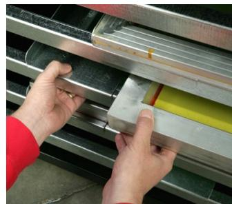
Les écrans à émulsion PLUS doivent toujours être séchés à l'horizontal, côté raclette vers le haut, pour optimiser la stabilité de l'émulsion sur la face d'impression de l'écran. En cas de séchage à la verticale, il est possible que l'émulsion coule avant de commencer à sécher, ce qui peut provoquer un « rainurage » visible de l'émulsion, ou une plus grande épaisseur de l'écran (EOM) vers le bas du cadre.
